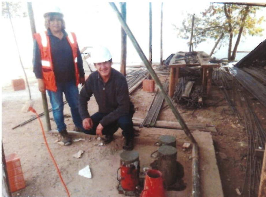
**FOTO N° 02.** Sacando las probetas para su posterior rotura.
